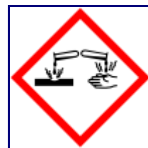
GHS05 - korozivní a žíravé látky
